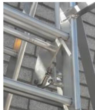
Une barre de plastique noire est fixée sur le câble et indique la fin de course du treuil pour le levage de la plateforme. Dès que cette pièce touche le treuil, il FAUT arrêter de mouliner :
