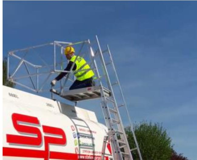
Après cette action, la structure est prête à être utilisée et vous pouvez monter sur le camion en restant à l'intérieur de la cage de la structure:
